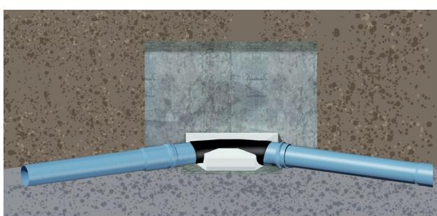
**5.** Påstøp mellom forankringsplate og rørbend skal utføres med betong tilsvarende B30 kvalitet og i henhold til vannrørleverandørenes spesifikasjoner.
