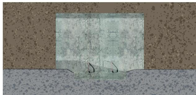
**2.** Fyll opp med pukk til ønsket nivå slik at rørstrek og bend får korrekt kotehøyde.
